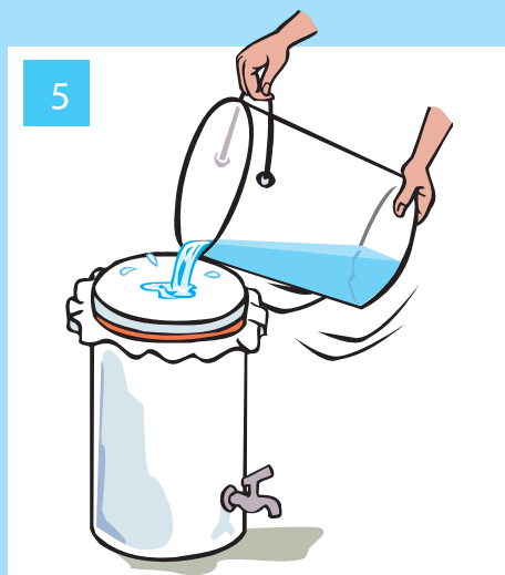
Đổ nước đã được xử lý vào bình đựng qua 1 miếng vải lọc
