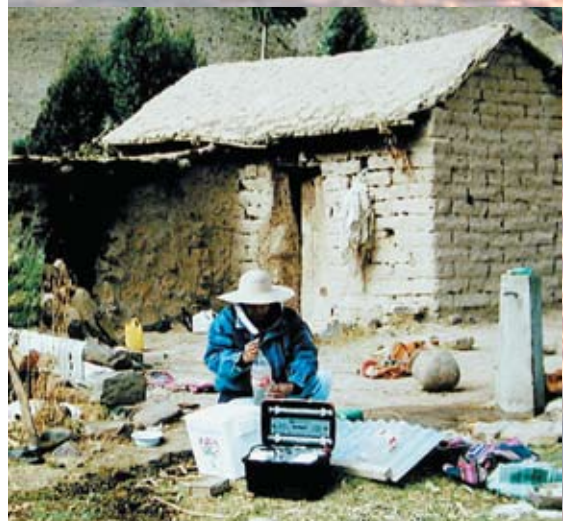
Testando a qualidade da água do SODIS e da água não fervida com o kit de teste de campo DelAgua.
