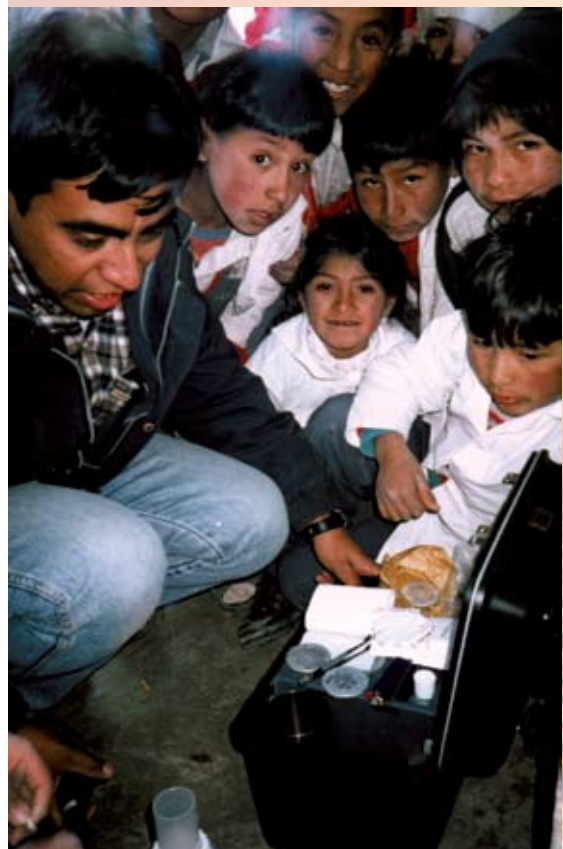
Usando o kit de teste de campo DelAgua para examinar a qualidade da água.
