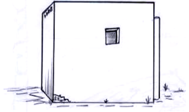
الماسورة القصيرة تعيق عملية التهوية
